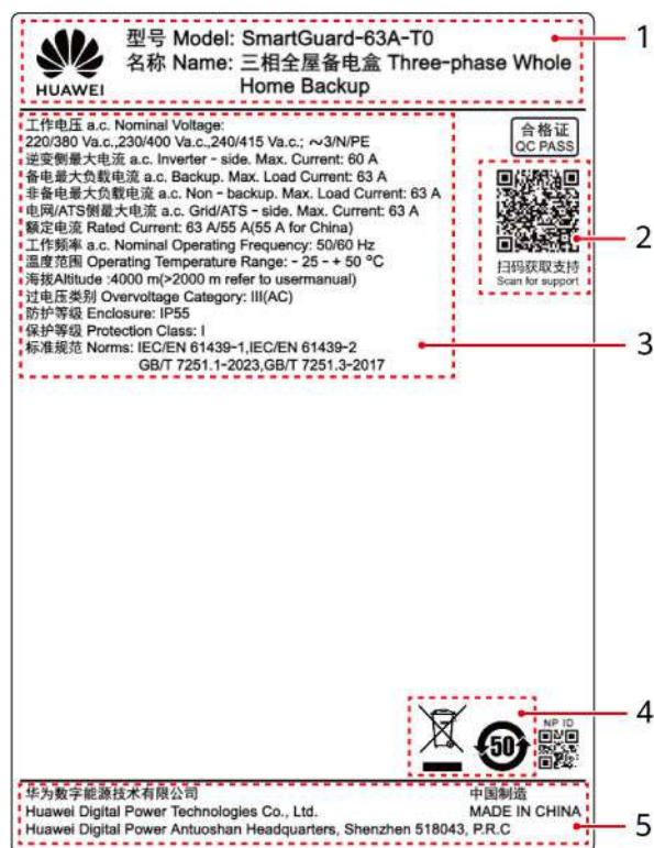
Figura 2-12 Targhetta (SmartGuard-63A-T0 come esempio)
