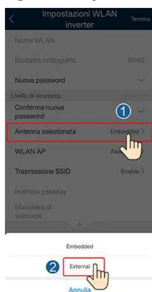
Figura 6-12 Impostazione dell'antenna esterna
