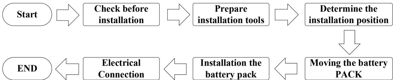
Figura 3 - Diagramma di flusso dell'installazione
